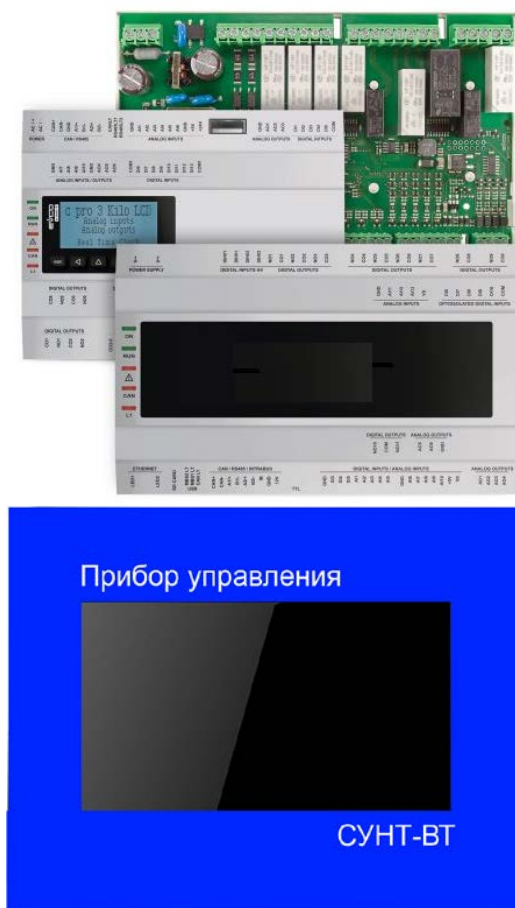
Рисунок 6 – Внешний вид плк и панели оператора.
