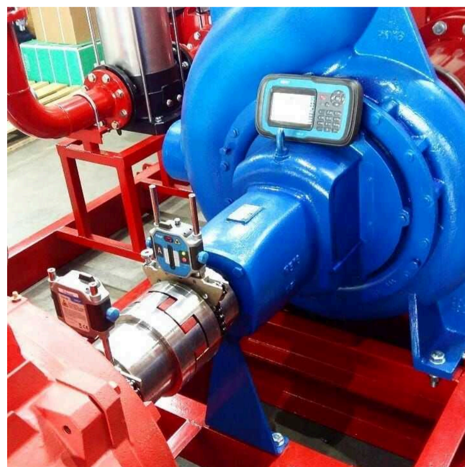
Рисунок – 12. Процесс юстировки консольных насосов
