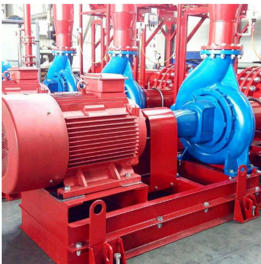
Рисунок – 12. Процесс юстировки консольных насосов
