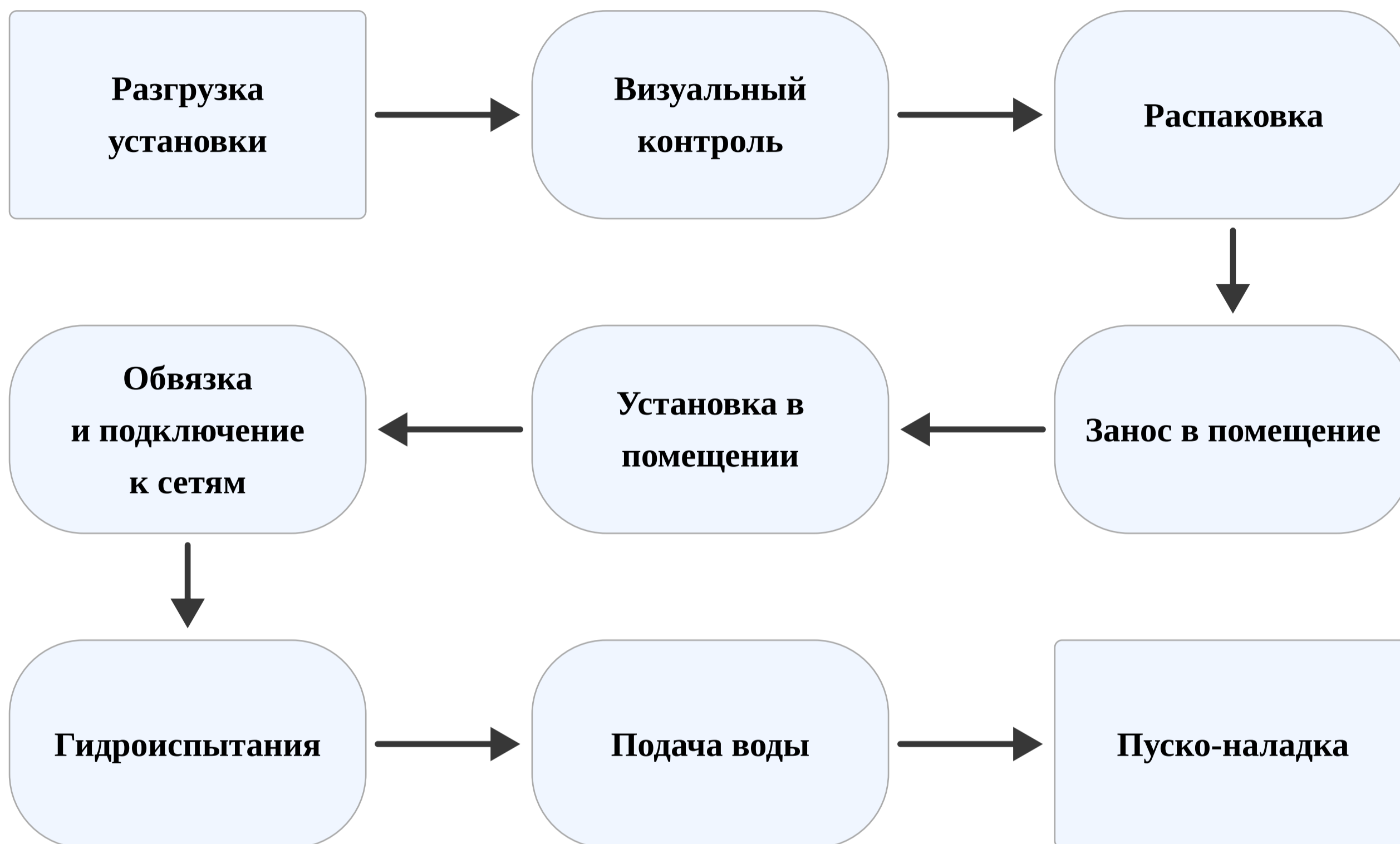
Рисунок – 4. Блок-схема монтажа НУ
