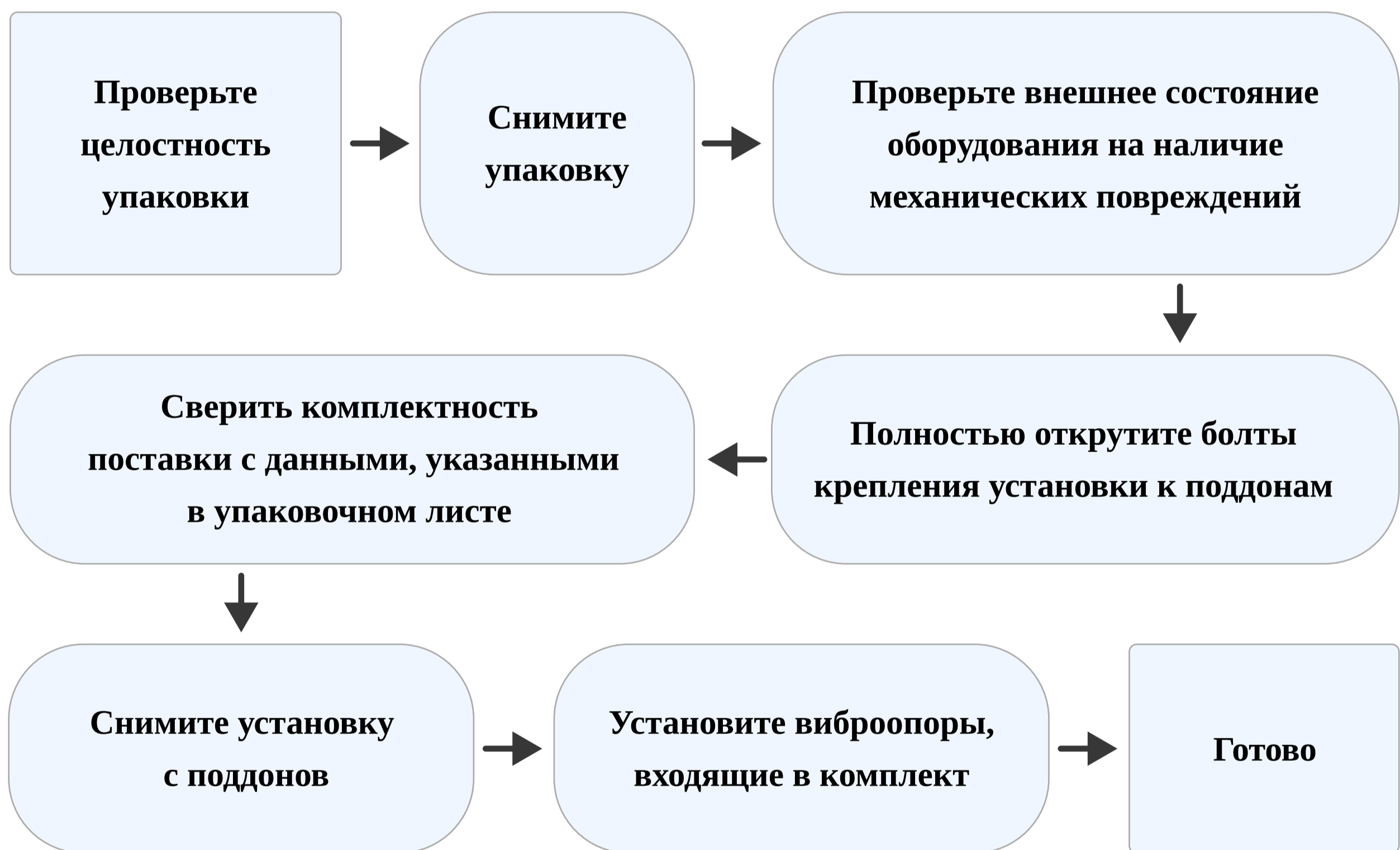
Рисунок – 8. Блок-схема последовательность действий при распаковке НУ
