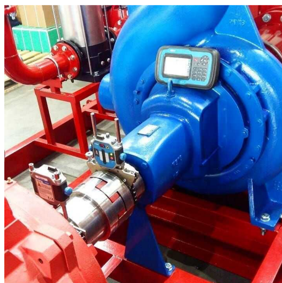
Рисунок – 12. Процесс юстировки консольных насосов
